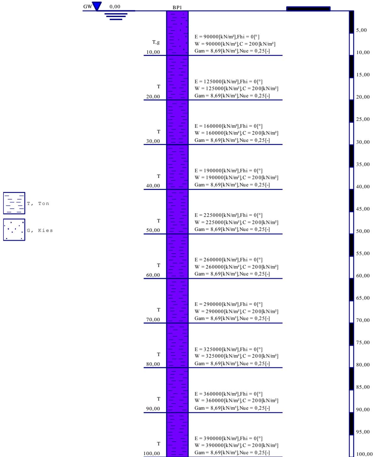
Bild 2.3 Darstellung des Bohrprofils
